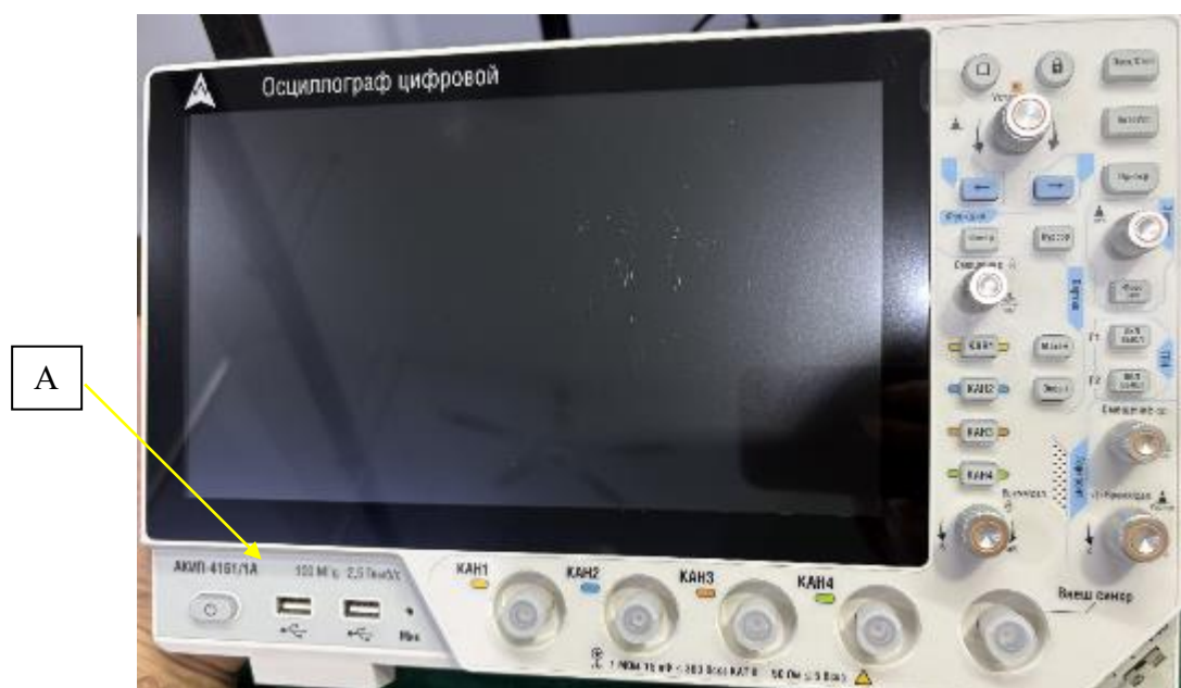
Рисунок 2 – Общий вид осциллографов модификаций АКИП-4161/1А, АКИП-4161/2А, АКИП-4161/3А и место нанесения знака утверждения типа (А)
