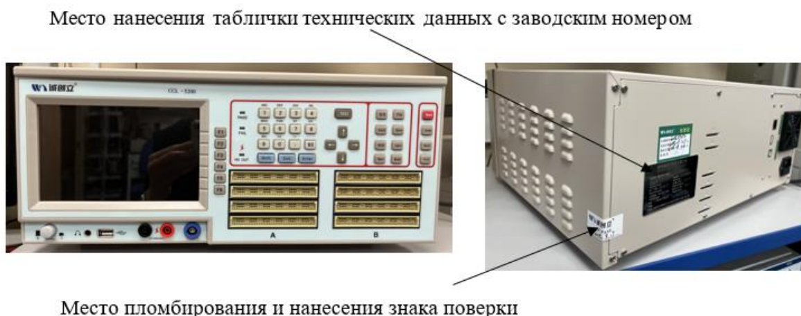
Рисунок 1 – Общий вид тестеров, место нанесения заводского номера, места пломбирования и нанесения знака поверки
