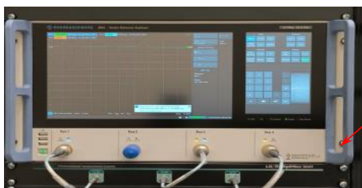
Рисунок 6 - Внешний вид четырехпортового анализатора цепей векторного ZNA 26 с указанием места пломбировки от несанкционированного доступа
