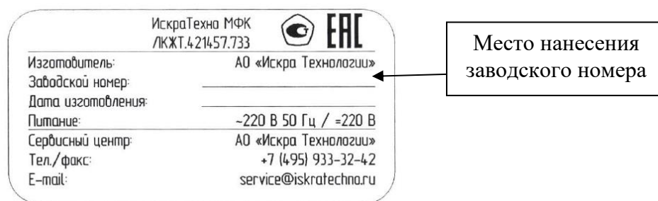
Рисунок 3 Паспортная табличка контроллеров с местом нанесения заводского номера
