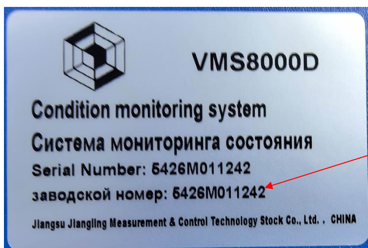
Рисунок 2. Пример внешнего вида маркировочной таблички систем мониторинга состояния VMS8000
