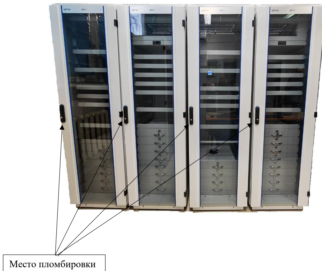
Рисунок 2 – Общий вид УСЧ-М (в составе: шкафы ЗИП-1, ЗИП-2, ЗИП-3, ЗИП-4), места нанесения пломбирования
