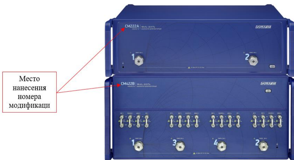
Рисунок 1 – Общий вид средства измерений и место для нанесения номера модификации (сверху модификация с двумя портами и в исполнении корпуса 3U, снизу модификация с четырьмя портами и исполнении корпуса 5U)
