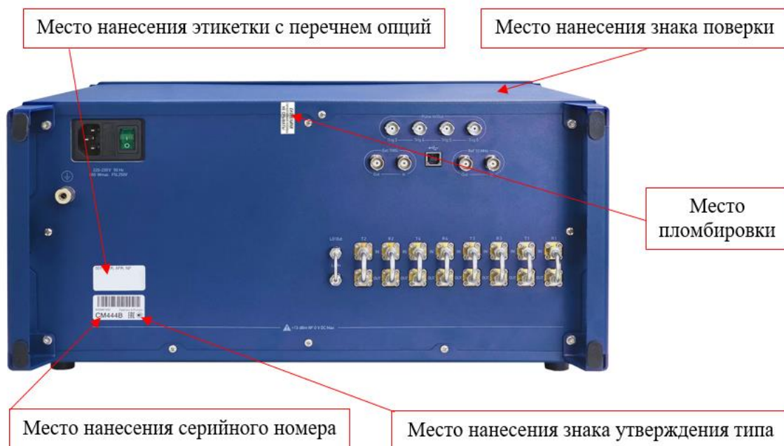
Рисунок 2 – Места нанесения серийного номера, идентифицирующего каждый экземпляр СИ, знака утверждения типа, этикетки с перечнем опций, знака поверки и схема пломбировки от несанкционированного доступа
