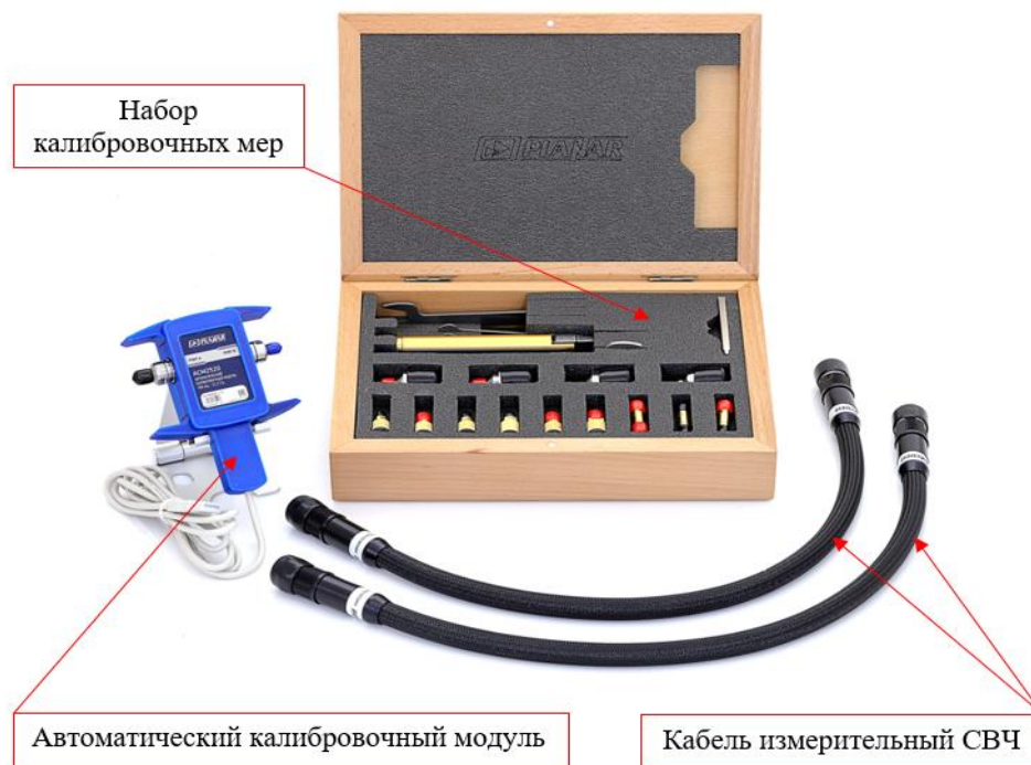
Рисунок 3 – Общий вид принадлежностей (набор калибровочных мер, автоматический калибровочный модуль, кабель измерительный СВЧ)
