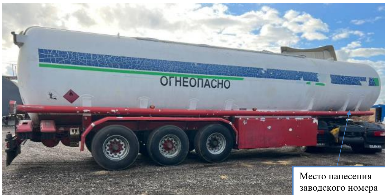
Рисунок 1 – Общий вид полуприцепа-цистерны WILLING SANZ 42.4 и место нанесения заводского номера
