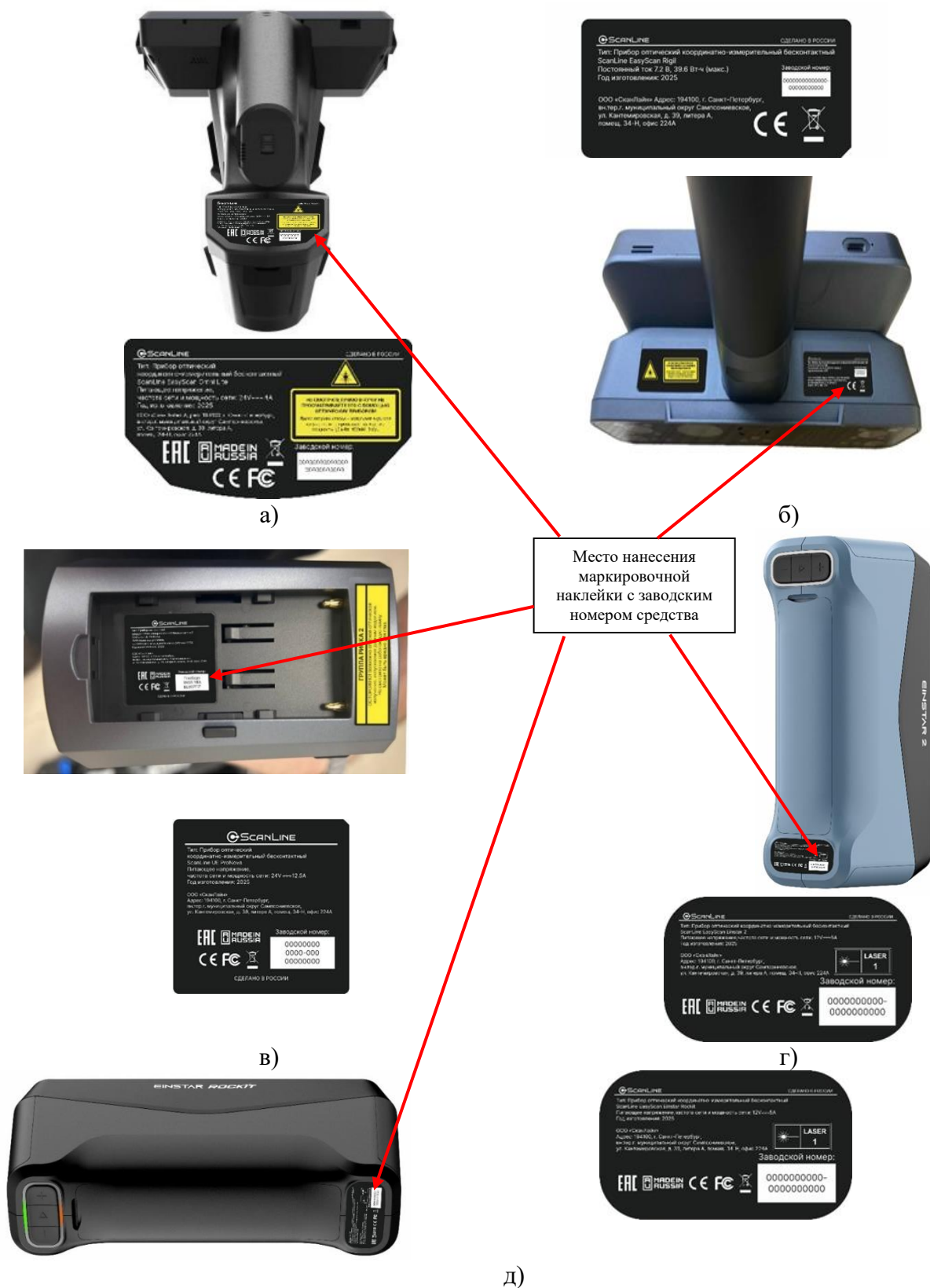
Рисунок 2 – Место расположения маркировочных наклеек с указанием заводского номера приборов оптических координатно-измерительных бесконтактных ScanLine EasyScan модификаций: а) ScanLine EasyScan Omni, ScanLine EasyScan Omni Lite; б) ScanLine EasyScan Rigil, ScanLine EasyScan Rigil Pro в) ScanLine EasyScan UE ProNova, ScanLine EasyScan UE ProNova+, г) ScanLine EasyScan Einstar 2; д) ScanLine EasyScan Einstar Rockit
