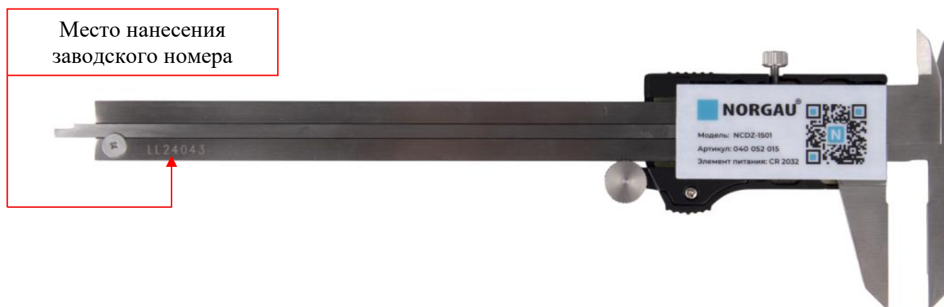
Рисунок 10 – Общий вид и место нанесения заводского номера
