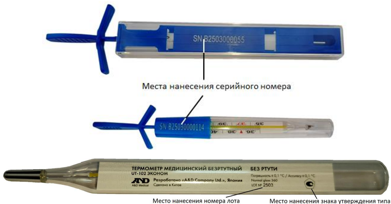
Рисунок 5 – Место нанесения серийного номера и знака утверждения типа
