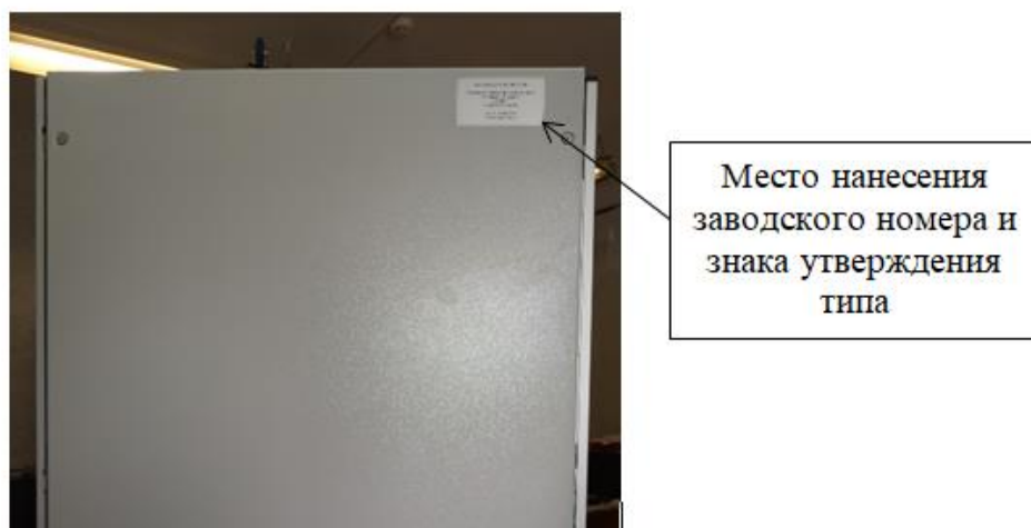
Рисунок 2 – Место нанесения обозначения изделия, заводского номера и знака утверждения типа
