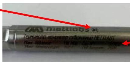
Рисунок 4 – Место нанесения серийного номера и знака утверждения типа на термоманометр
