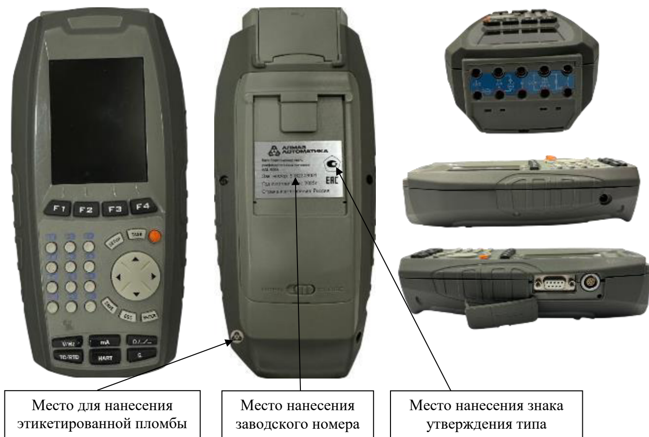
Рисунок 1 – Общий вид калибраторов модификации AAL-508A с указанием мест нанесения знака утверждения типа, заводского номера и этикетированной пломбы завода-изготовителя
