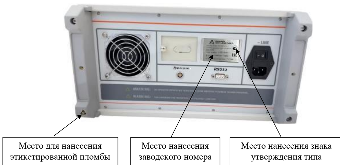
Рисунок 2 – Общий вид калибраторов модификации AAL-508B с указанием мест нанесения знака утверждения типа, заводского номера и этикетированной пломбы завода-изготовителя
