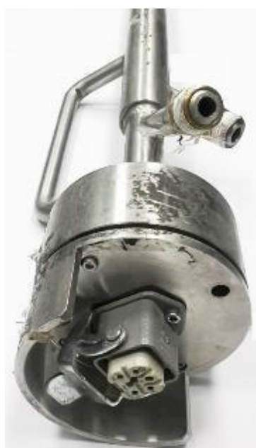
Рисунок 1 – Общий вид пирометров модели Gold Cup Probe 300/1300C ZT9558 с указанием места нанесения заводского номера
