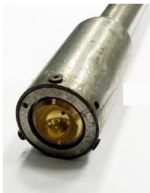
Рисунок 1 – Общий вид пирометров модели Gold Cup Probe 300/1300C ZT9558 с указанием места нанесения заводского номера
