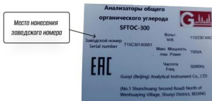
Рисунок 2 – Общий вид идентификационной таблички с указанием места нанесения заводского номера
