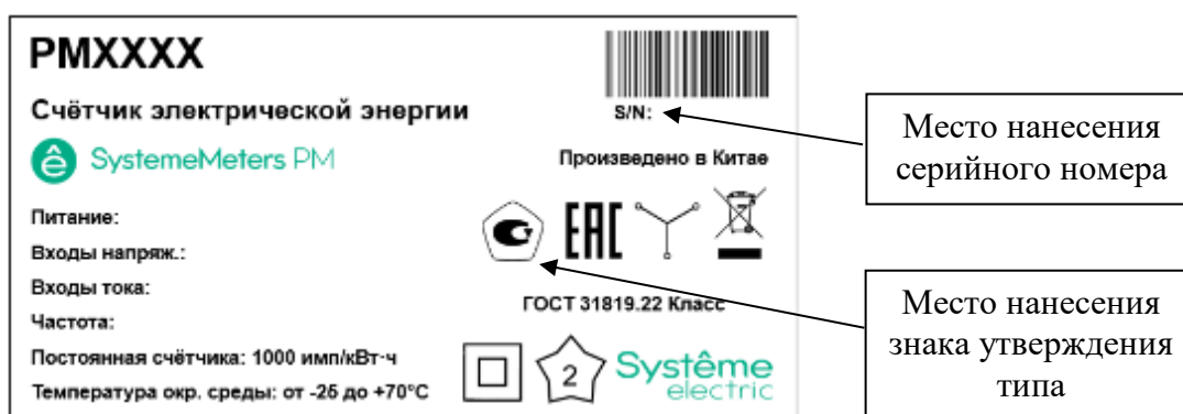
Рисунок 7 – Макет маркировочной наклейки с указанием места нанесения знака утверждения типа, места нанесения серийного номера
