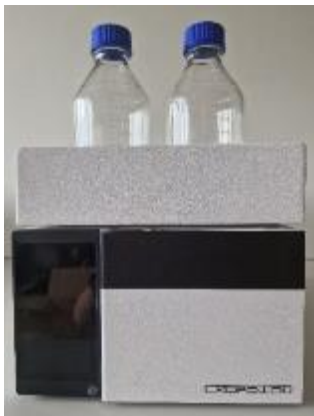
Рисунок 2 – Общий вид хроматографов жидкостных тип 1000. Моноблочное исполнение (с ФФД-1000)
