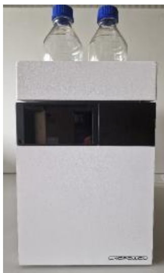
Рисунок 3 – Общий вид хроматографов жидкостных тип 1000. Моноблочное исполнение (с иными детекторами)
