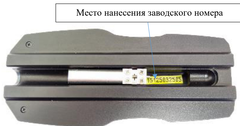
Рисунок 4 – Место нанесения заводского номера для профилометров модификаций MS-221 и MS-221P
