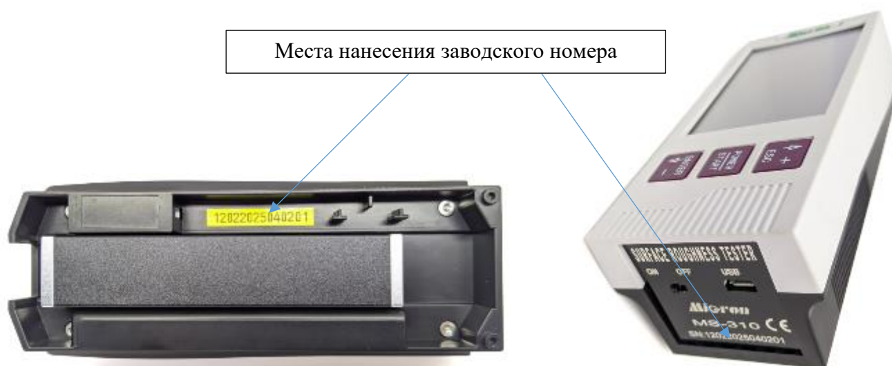
Рисунок 5 – Места нанесения заводского номера для профилометров модификации MS-310
