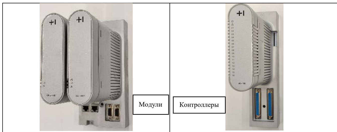
Рисунок 3 – Вид модуля ввода/вывода и модуля контроллера
