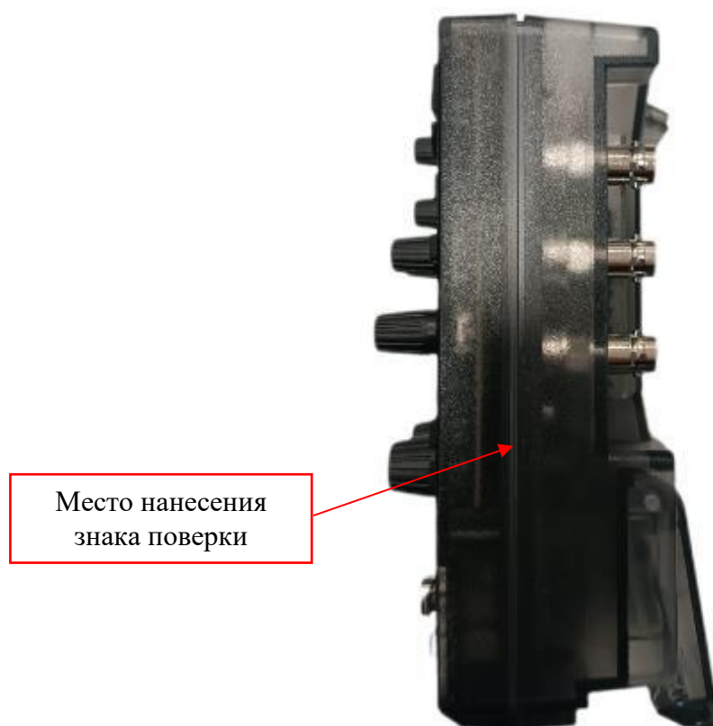
Рисунок 3 – Боковая панель осциллографов RIGOL MHO9ZZ
