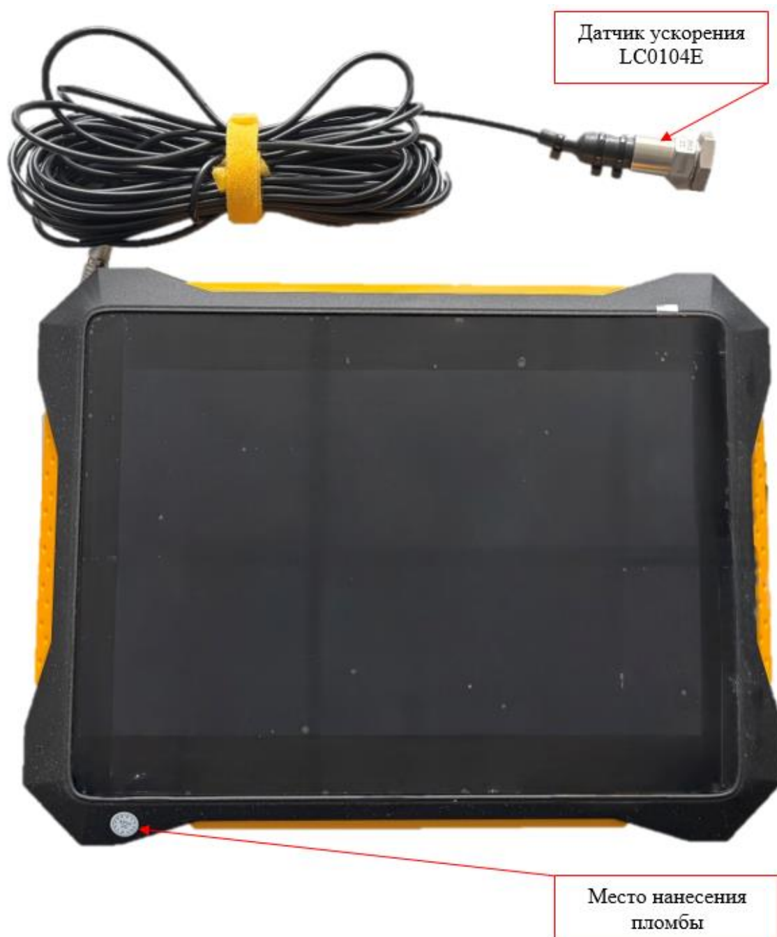
Рисунок 3 – Общий вид модификации МИТ КИК 2-2К, передняя панель основного модуля и датчик ускорения LC0104E
