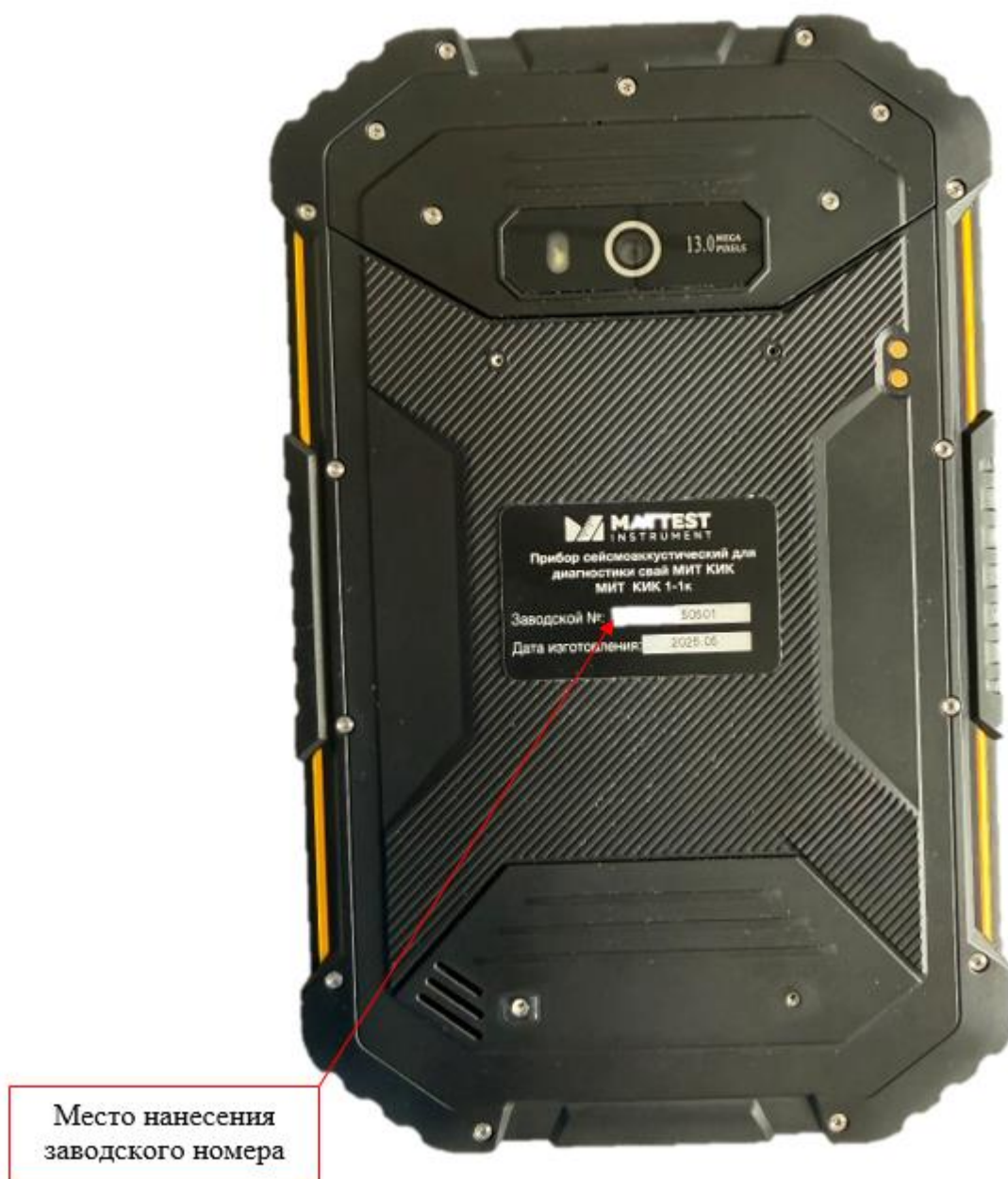
Рисунок 2 – Общий вид модификации МИТ КИК 1-1К, задняя панель основного модуля
