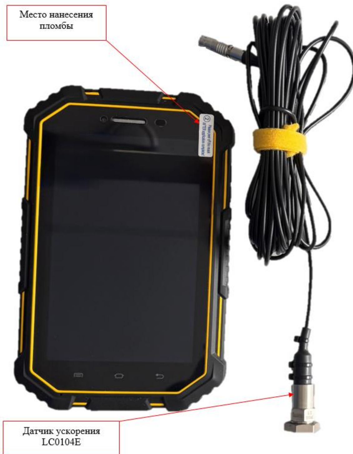
Рисунок 1 – Общий вид модификации МИТ КИК 1-1К, передняя панель основного модуля и датчик ускорения LC0104E
