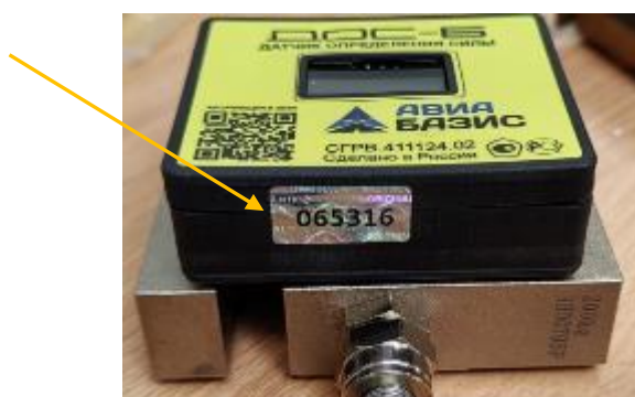
Рисунок 2 – Схема пломбировки от несанкционированного доступа
