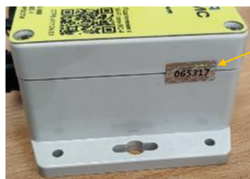
Рисунок 2 – Схема пломбировки от несанкционированного доступа
