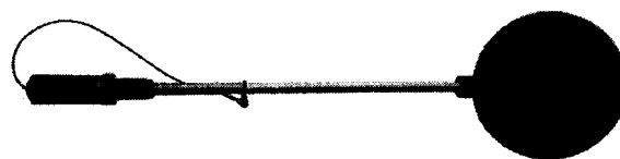
Рисунок 1.3 – Фотографии общего вида ионизационных камер из состава дозиметров (изображения носят иллюстративный характер)
