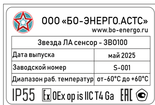
Рисунок 4б – Идентификационная табличка на обратной панели сенсоров Звезда ЛА-ЗВО100 с местом для нанесения заводского номера
