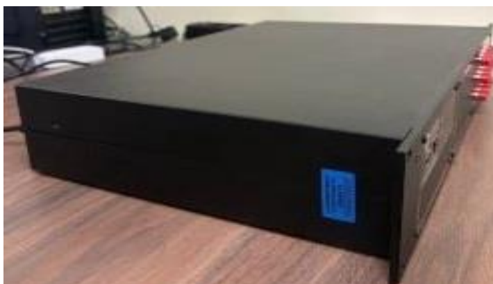
Рисунок 5 – Пломбировка стикером газоанализатора
