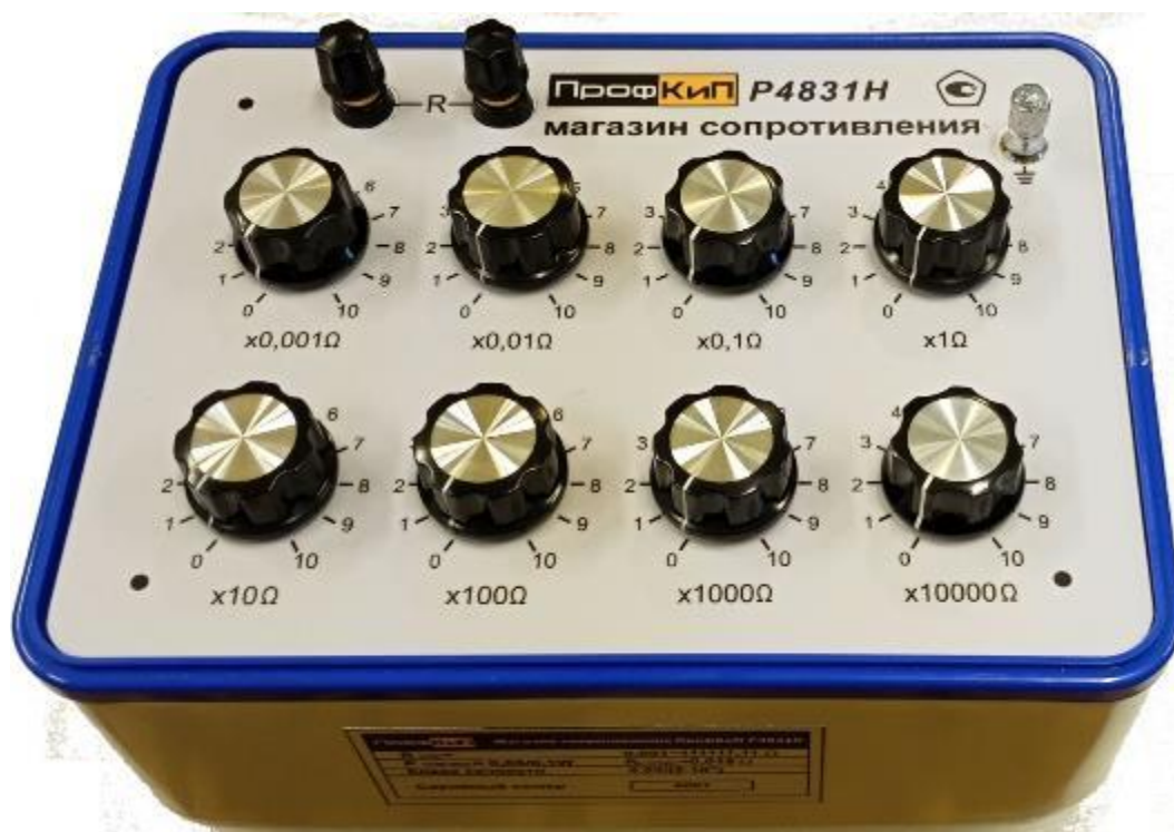
Рисунок 1 – Общий вид магазинов сопротивления модификации ПрофКиП Р4831Н
