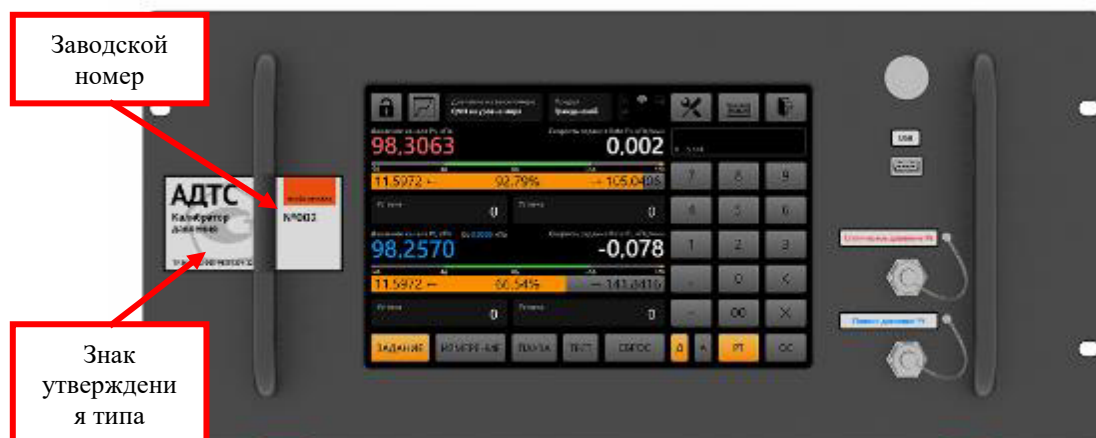
Рисунок 3 – Внешний вид калибратора (лицевая панель исполнения для монтажа в телекоммуникационную стойку), места нанесения заводского номера и знака утверждения типа
