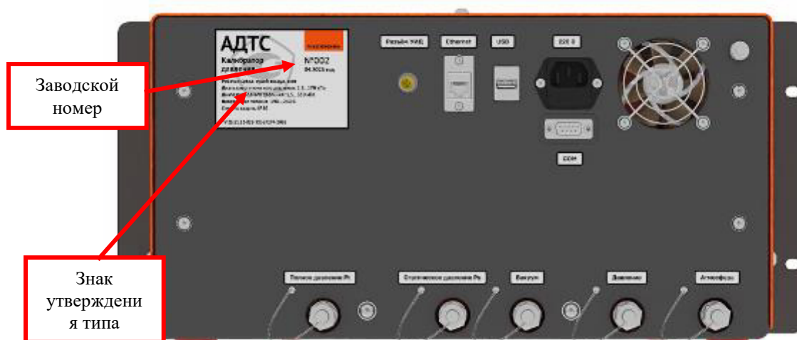
Рисунок 4 – Внешний вид калибратора (задняя панель исполнения для монтажа в телекоммуникационную стойку), места нанесения заводского номера и знака утверждения типа
