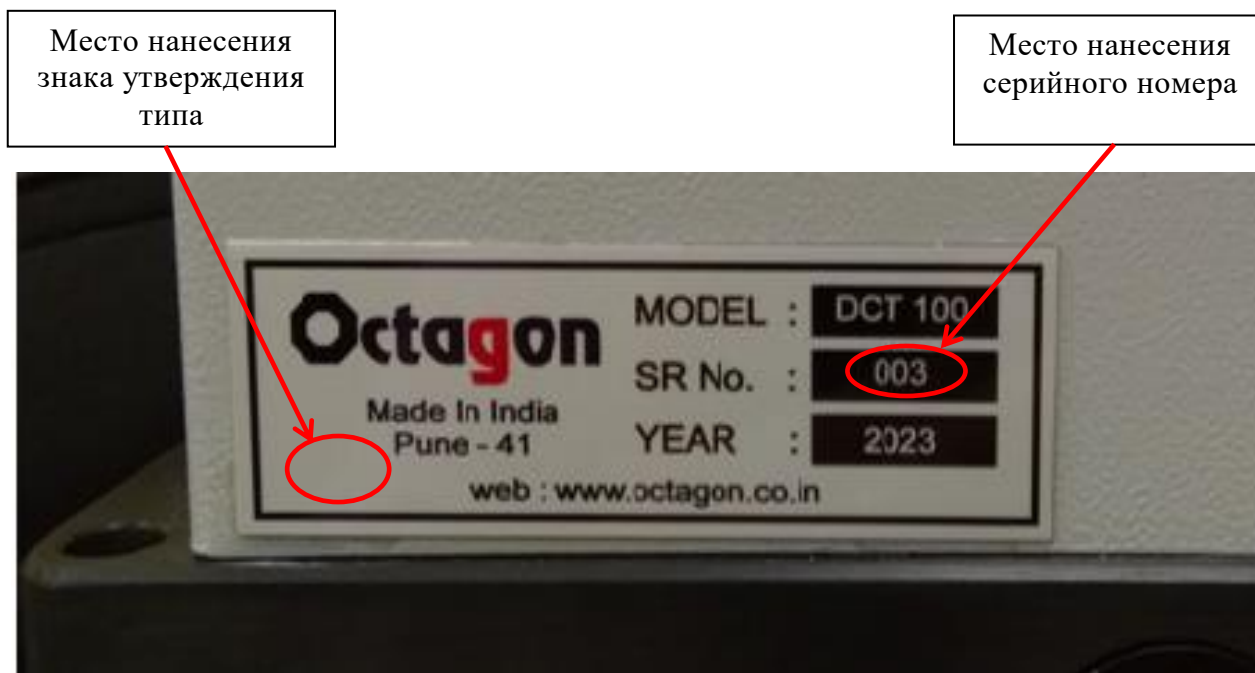
Рисунок 4 – Места нанесения знака утверждения типа и серийного номера на маркировочную табличку приборов DCT модификации DCT 100
