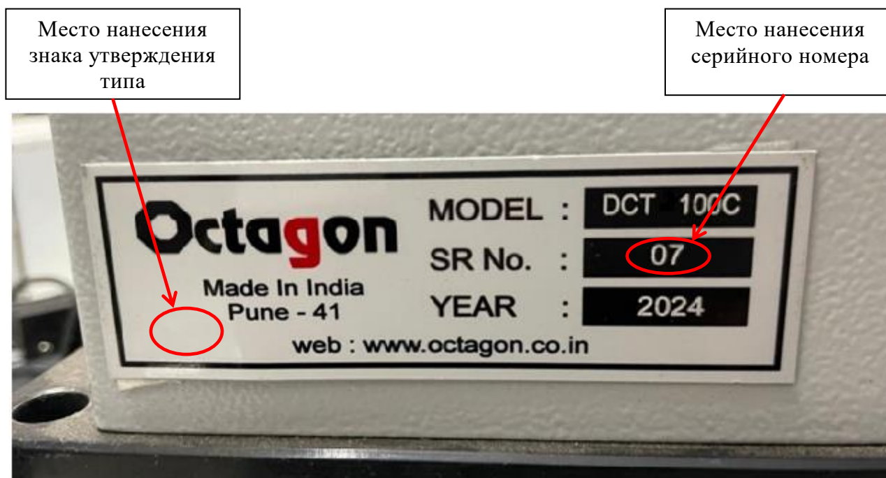
Рисунок 5 – Места нанесения знака утверждения типа и серийного номера на маркировочную табличку прибора DCT модификации DCT 100C
