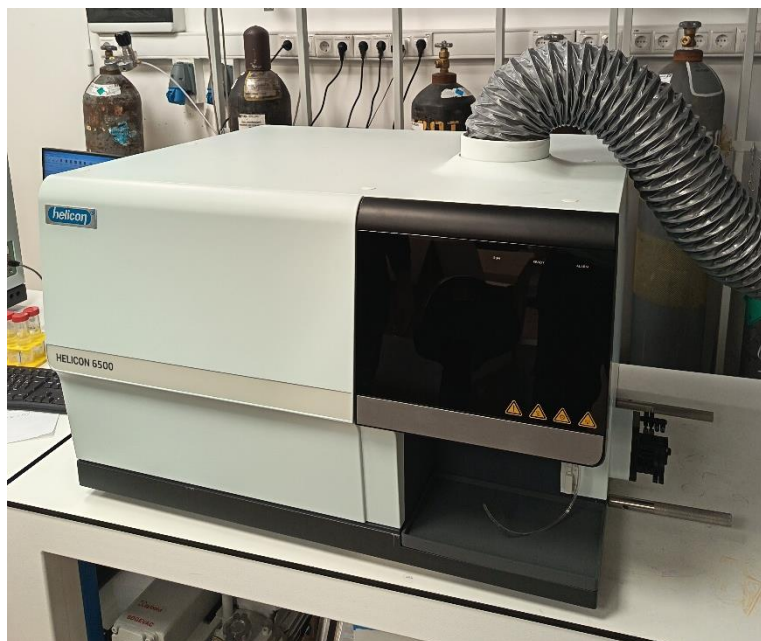
Рисунок 1 – Общий вид спектрометров эмиссионных с индуктивно-связанной плазмой HELICON 6500
