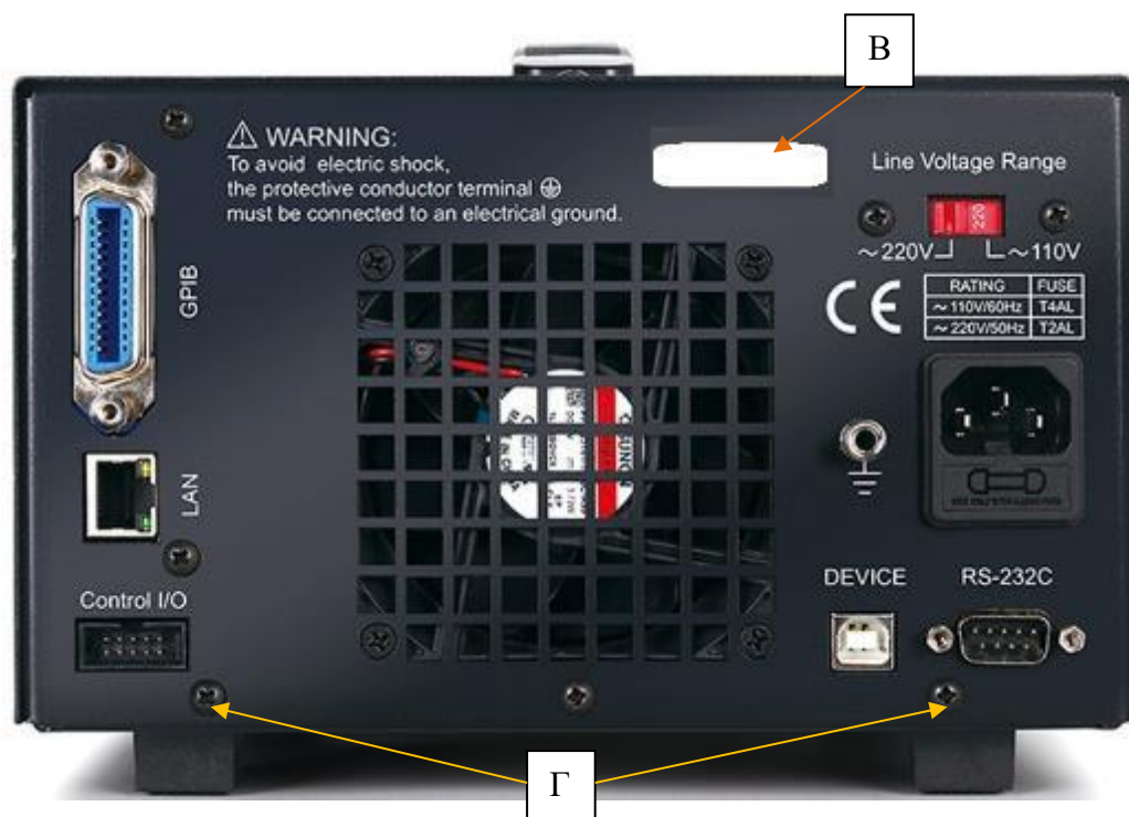
Рисунок 5 – Вид задней панели источников АКПП-1502 с местами нанесения серийного номера (В) и пломбировки от несанкционированного доступа (Г)
