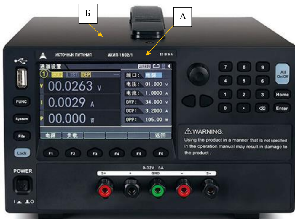
Рисунок 1 – Общий вид источника модификации АКІП-1502/1 с местами нанесения знака утверждения типа (А) и знака поверки (Б)
