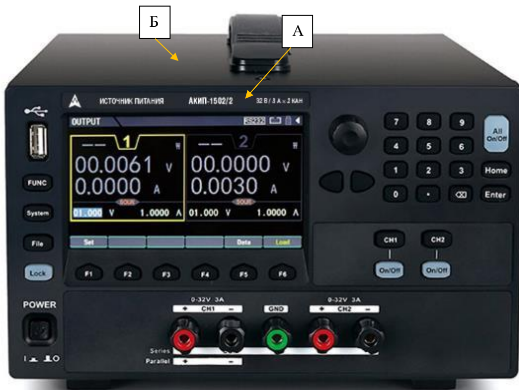
Рисунок 2 – Общий вид источника модификации АКІП-1502/2 с местами нанесения знака утверждения типа (А) и знака поверки (Б)
