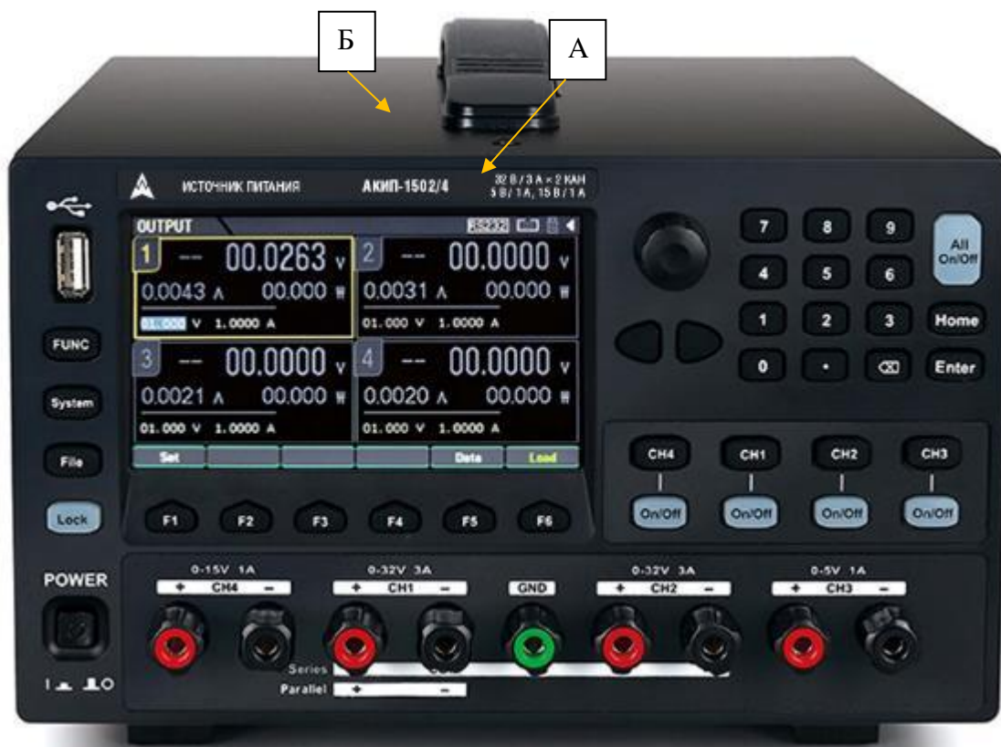
Рисунок 4 – Общий вид источника модификации АКИП-1502/4 с местами нанесения знака утверждения типа (А) и знака поверки (Б)
