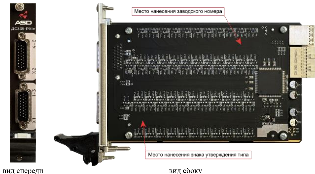
Рисунок 1 – Общий вид модулей с указанием места нанесения заводского номера и знака утверждения типа
