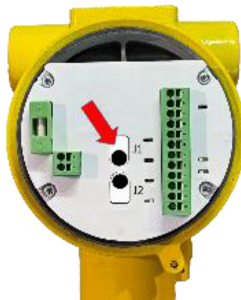
Р и с у н о к 2 – Схема пломбировки от несанкционированного доступа, обозначение места нанесения знака поверки расходомеров-счетчиков газа ультразвуковых ВЗЛЕТ РГ-М
