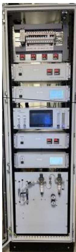
Рисунок 1 – Общий вид шкафа с газоанализаторами ЕТ-909
