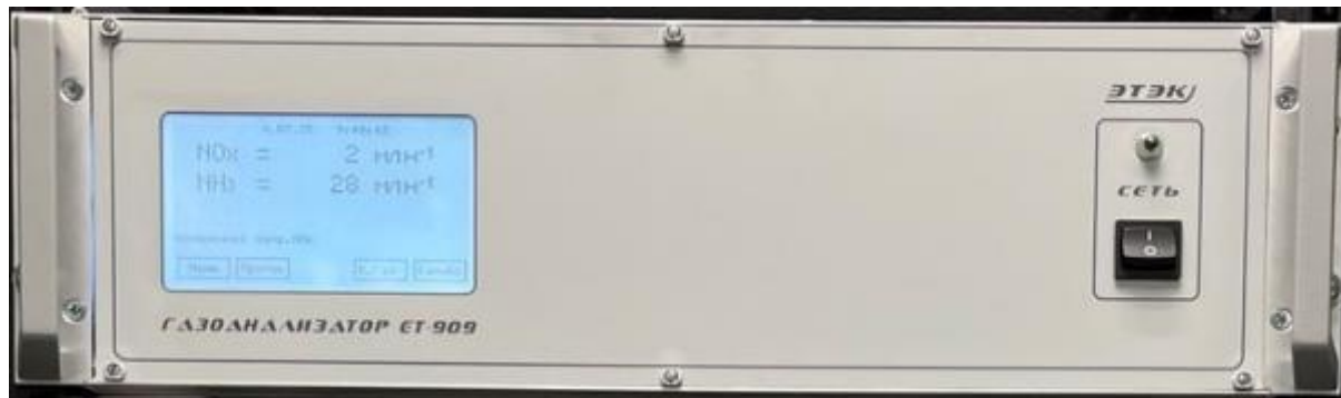
Рисунок 2 – Общий вид газоанализаторов ЕТ-909
