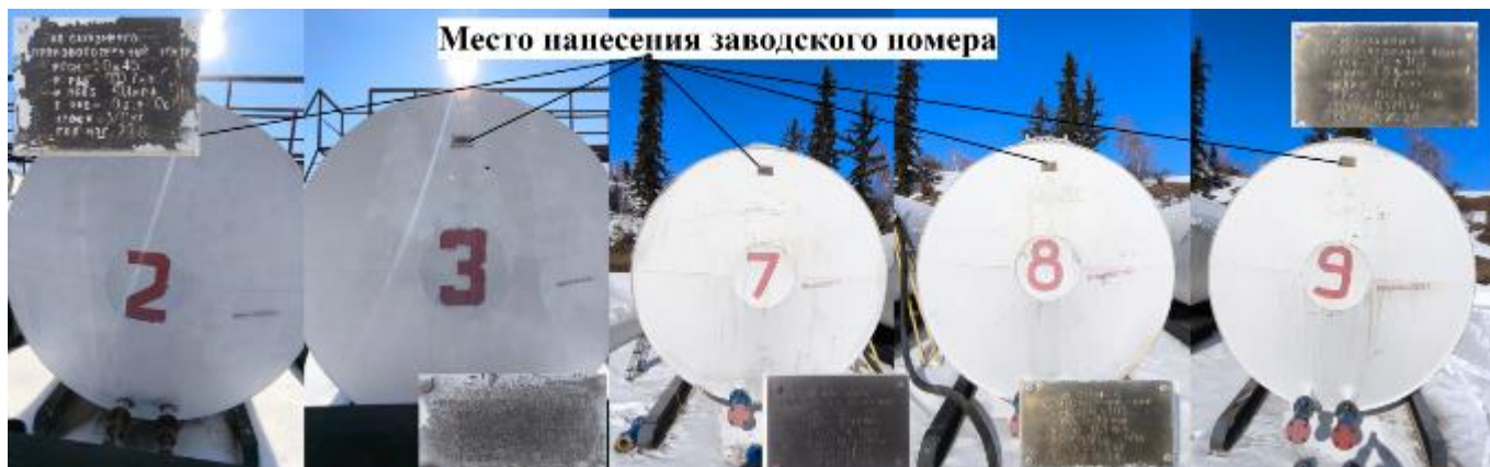
Рисунок 1 – Общий вид резервуаров горизонтальных стальных цилиндрических РГС-50 с указанием места нанесения заводских номеров
