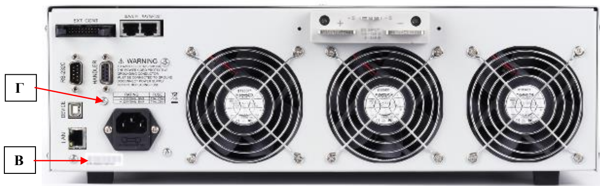
Рисунок 4 – Вид задней панели нагрузок модификаций АКПП-1397-150-160-700, АКПП-1397-150-100-1000, АКПП-1397-150-200-1000 с местами нанесения серийного номера (В) и пломбировки от несанкционированного доступа (Г)
