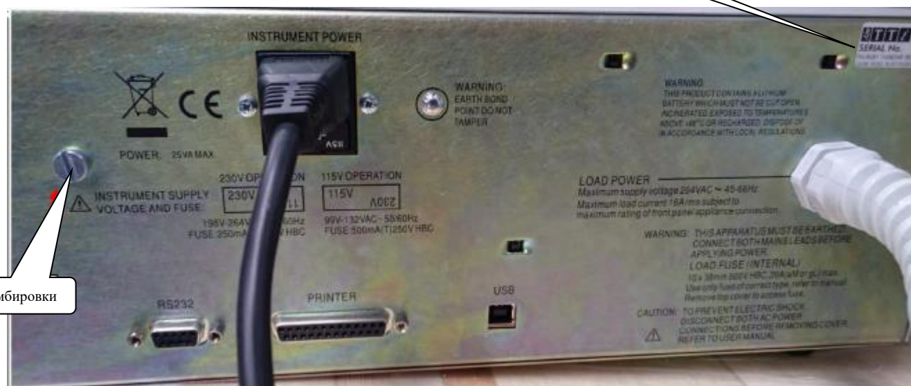
Рисунок 1 – Общий вид измерителей фликера и гармоник HA1600A, обозначение мест нанесения знака утверждения типа, заводского номера и схемы пломбировки от несанкционированного доступа
