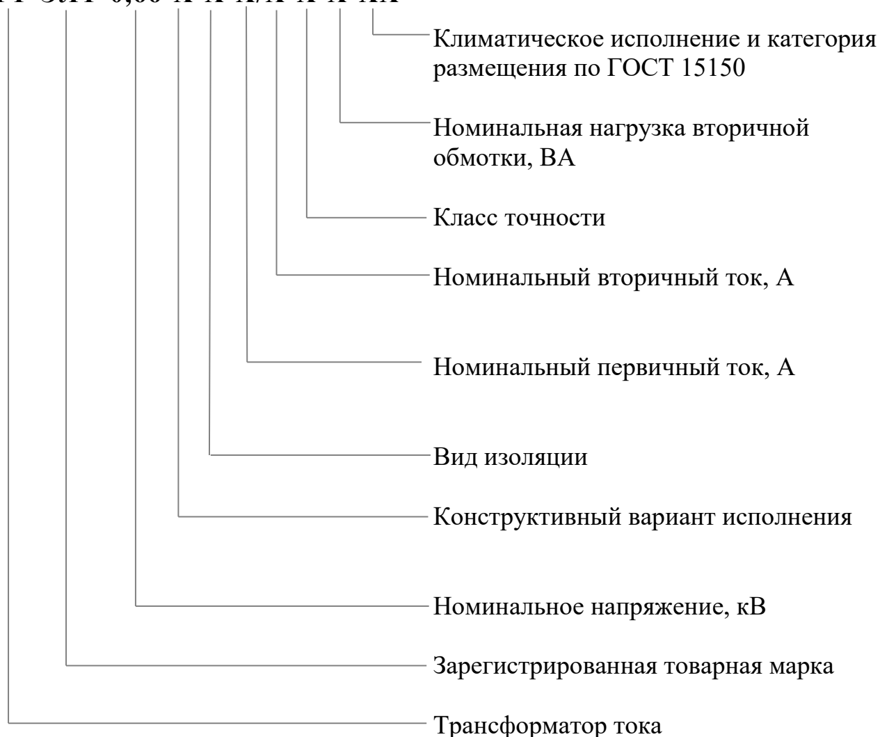
Рисунок 1 – Расшифровка условного обозначения трансформаторов
