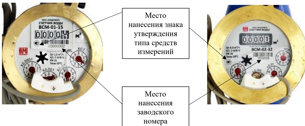
Рисунок 4 – Места нанесения заводского номера и знака утверждения типа средств измерений у счётчиков ВСМ
