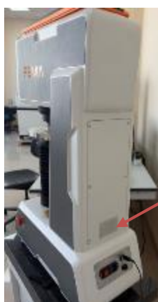
Рисунок 3 – Вид задней панели корпуса твердомеров с указанием места нанесения маркировочной таблички
