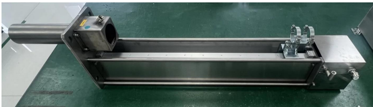
Рисунок 2 – Общий вид устройства автоматической защиты от втягивания GS-Q60-IIIG1
