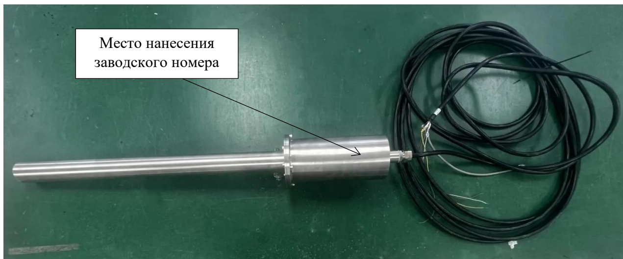
Рисунок 1 – Общий вид кожуха, в котором расположен измерительный модуль камер
