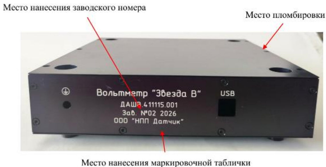
Рисунок 2 – Общий вид вольтметров селективных «Звезда В» с указанием мест пломбировки, места нанесения заводского номера и маркировочной таблички
