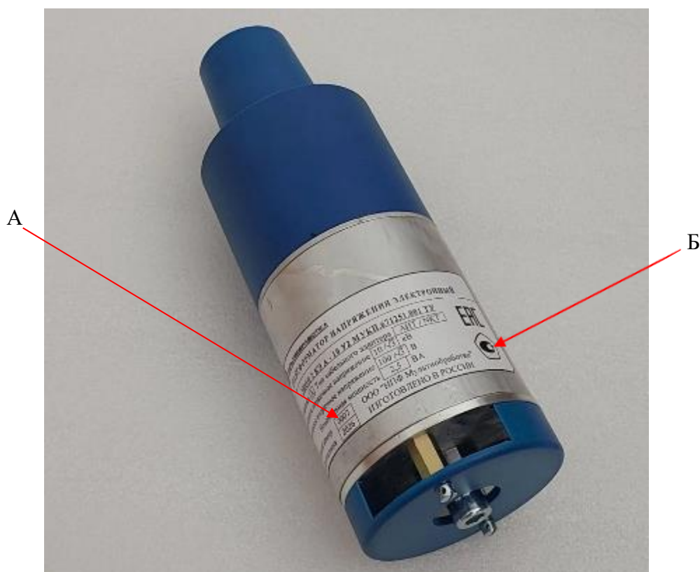
Рисунок 1 – Общий вид средства измерений, предназначенного для монтажа в кабельные адаптеры, обозначение места нанесения заводского номера (А) и места нанесения знака утверждения типа (Б)
