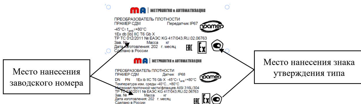
Рисунок 2 – Места нанесения заводского номера и знака утверждения типа на ЭП
