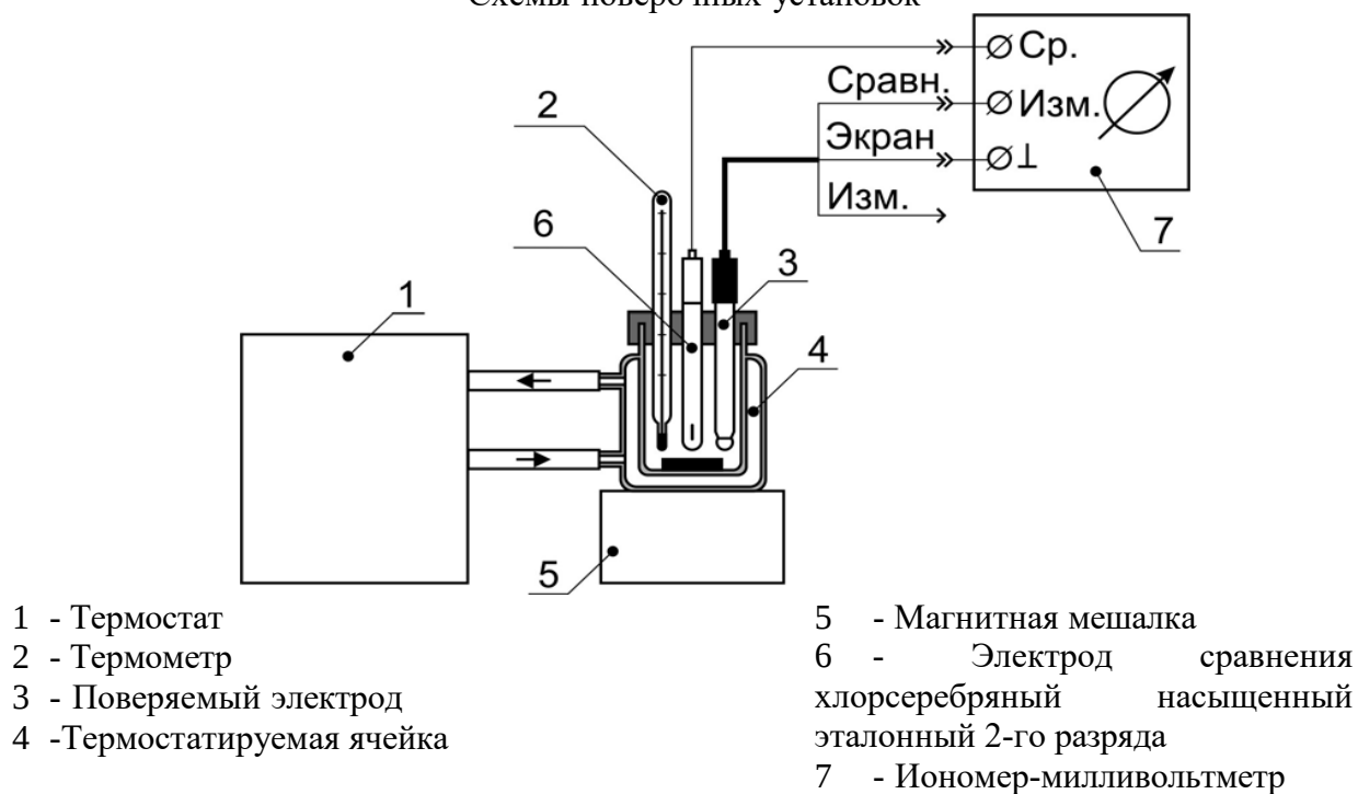
Рисунок В.1 – Схема установки для определения потенциала встроенного электрода сравнения.
