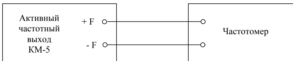
Рисунок П1.2. Электрическая схема подключения эталонного частотомера при поверке частотных выходов каналов КМ-5.
