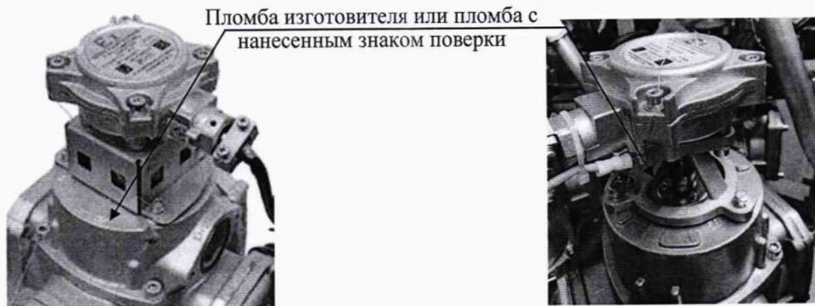
Рисунок 1 – Схемы пломбировки генераторов импульсов
