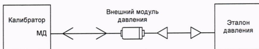
Рисунок Б.2 – Схема поверки калибратора в режиме измерений давления внешним модулем давления
