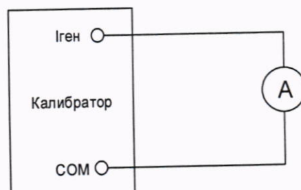
Рисунок Б.8 – Схема поверки калибратора в режиме воспроизведения силы постоянного тока методом прямых измерений
