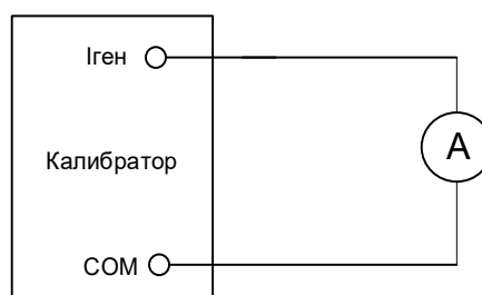
Рисунок Б.8 – Схема поверки калибратора в режиме воспроизведения силы постоянного тока методом прямых измерений
