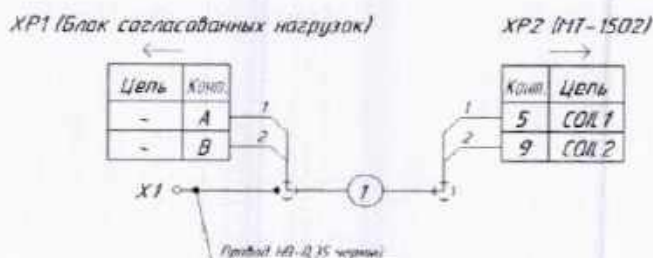
Рисунок К.4 – Схема кабеля МТ-1502/1505-БСН для подключения «Оснастки к МПС-1500 на базе МТ-1502/МТ-1505» (разъем питания) к БСН (Кабель 3)
