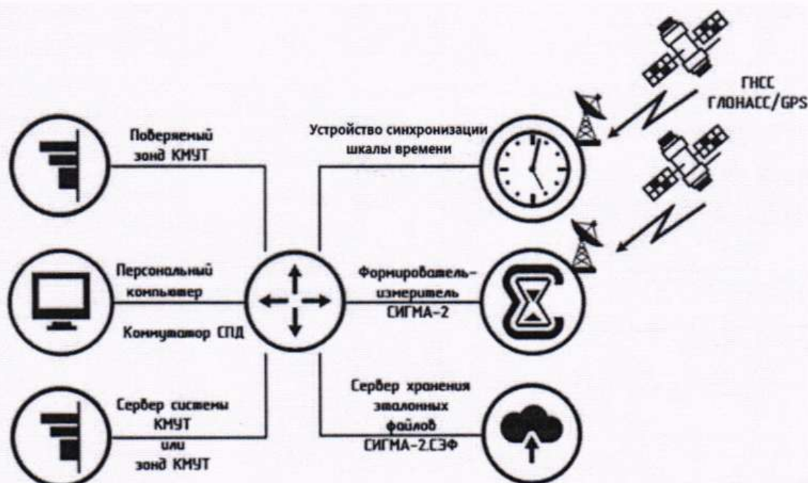
Рисунок 2 – Схема измерений для проведения опробования при первичной поверке
