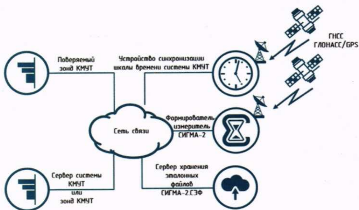
Рисунок 3 – Схема измерений для проведения опробования при периодической поверке
